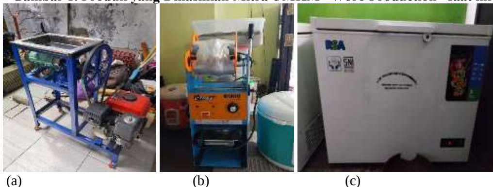
Gambar 2. Peralatan teknologi yang dimiliki oleh mitra UMKM “Woro Production”, meliputi (a) mesin penggiling bumbu pecel; (b) mesin cup sealer ; (c) freezer
