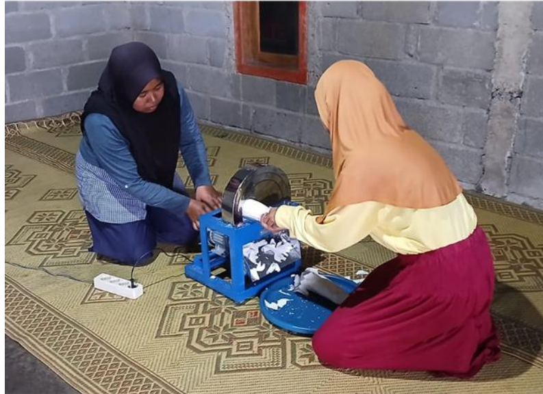
Gambar 6. Introduksi Mesin Perajang Singkong
